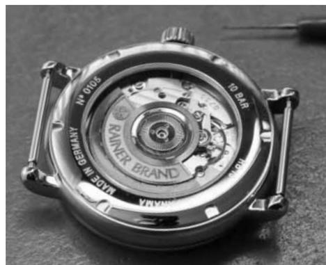
Die Gravur in der Glaseinfassung des Bodens gibt neben den Angaben zum Modell und zur Wasserdichtheit auch Auskunft über die spezifische Nummer der Uhr zur Identifikation. Alle RAINER BRAND-Uhren werden fortlaufend einzeln nummeriert.
